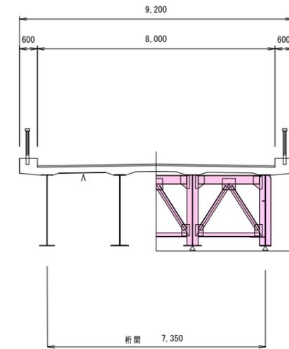
桁塗装工 A=1513.4 m<sup>2</sup>
